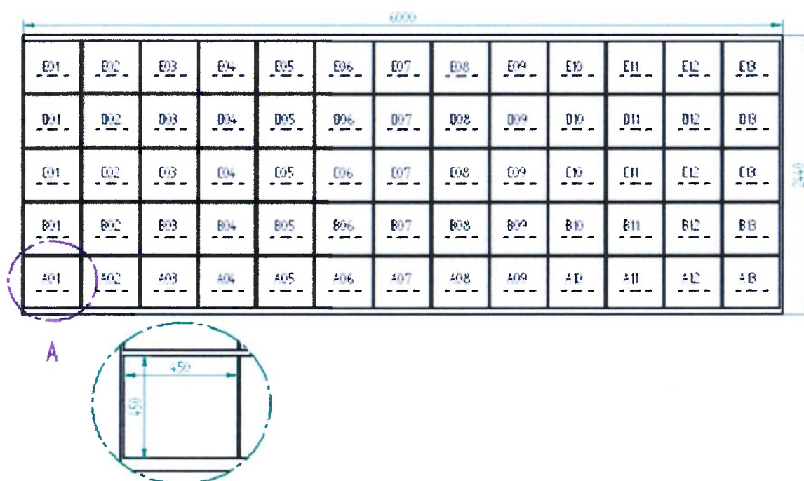
Figura 4 - Amostragem da chapa utilizada no trabalho (dimensões em milímetros).
